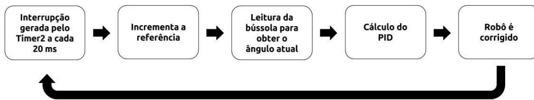
Figura 5. Fluxograma do método utilizado para fazer o robô deslocar-se em trajetórias curvas
